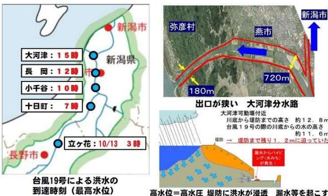
では水位は1.2mまで迫っていた、今回は破壊に至っていないが、この状態がさらに続けば堤防が破壊された可能性もあった(図2, 3)。
