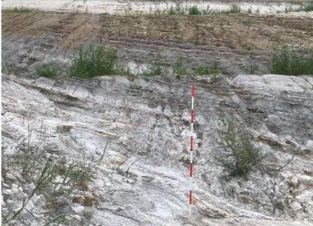
図 16 スレーキングにより泥滓化した Nz 凝灰岩
