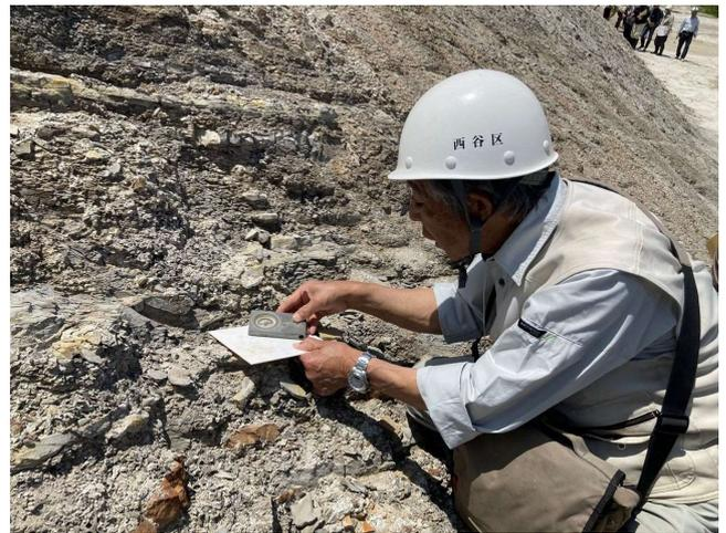
図 19 走向・傾斜の測定(測定は荒川勝利先生)
