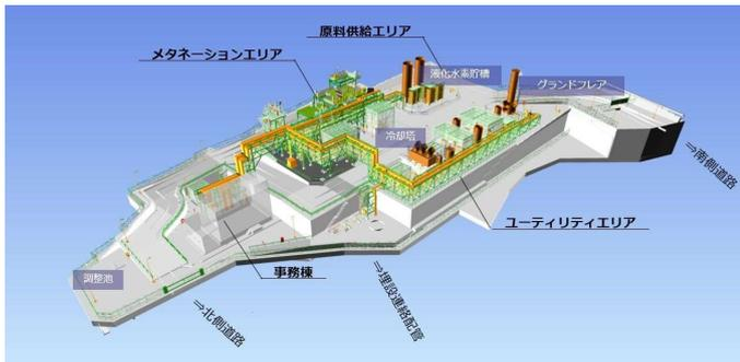
図 4 400 Nm<sup>3</sup>-CO<sub>2</sub>/h 試験設備全体配置図(3DModel)
