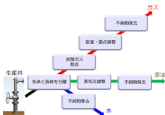
図 6 越路原プラント生産流体プロセス概念図
