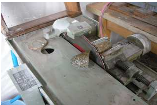
【岩石カッター1号機での石の切断】
