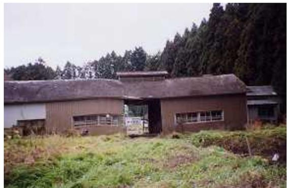
写真2 支持力不足で沈下した建物(右側)。一種の不同沈下(宮城県のある農場の建物)。
