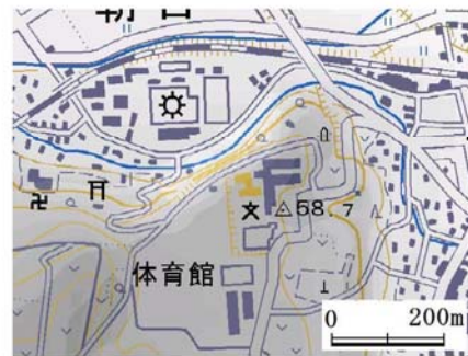
(図F) 比較のために50mメッシュ標高データを用いた陰影図
