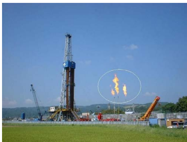
図 1 坑井掘削後のテストでの着火
