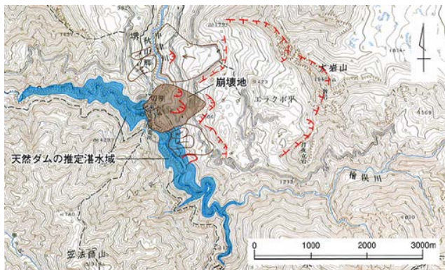
図-18 切明の崩壊と中津川の災害状況
