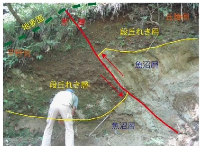
写真 13. 写真の左上から右下に断層が通る。断層は魚沼層と段丘れき層を切っている。右側の地盤（丘陵側）が左側の平野側にせり上がり、地表面も変形している。
