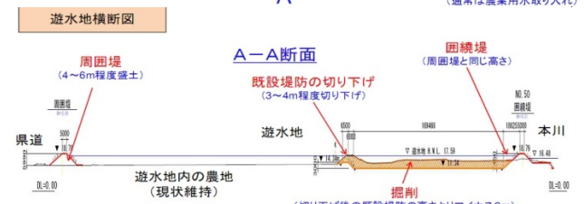
図 4 五十嵐川遊水地平面図・横断面 (資料提供(図 3・4):新潟県三条地域振興局地域整備部)
