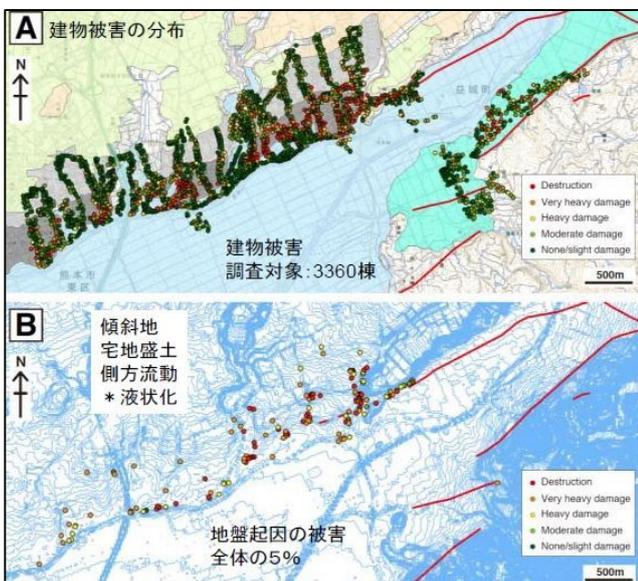
図4 建物被害の分布(A)と地盤起因の被害(B)
