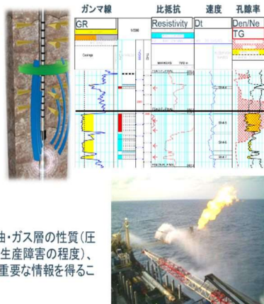
図2 試験井でのデータ取得
